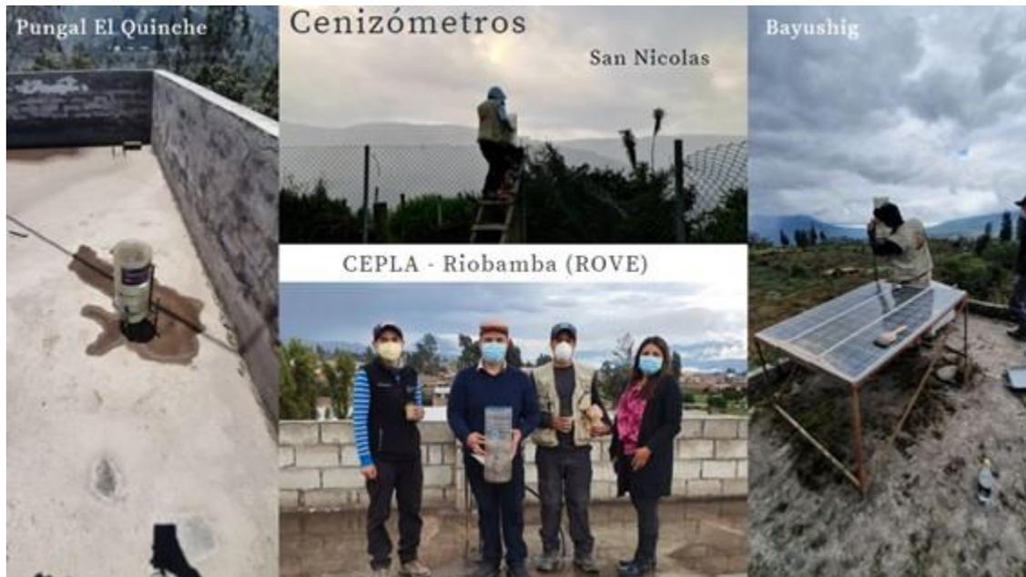
**Figura 3.** Muestreo y mantenimiento de la red de cenizómetros en San Nicolas, Pungal-El Quinche, Bayushig y Riobamba (CEPLA parte de la Red de Observadores Volcánicos-ROVE), 12/03/2021.
