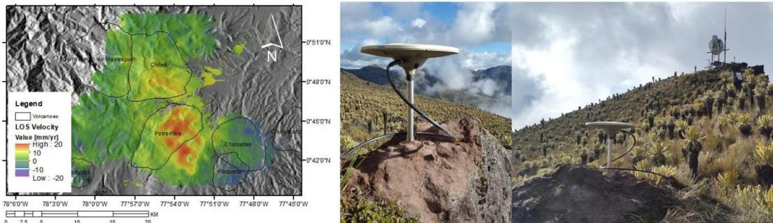
**Figura 1.** Izquierda: Mapa de velocidades de la zona de los volcanes: Potrerillos, Chiles y Cerro Negro. Derecha: Nuevas bases cGPS (“Sistema de Posicionamiento Global Continuo” por sus siglas en inglés) instaladas en el volcán Cerro Negro.
