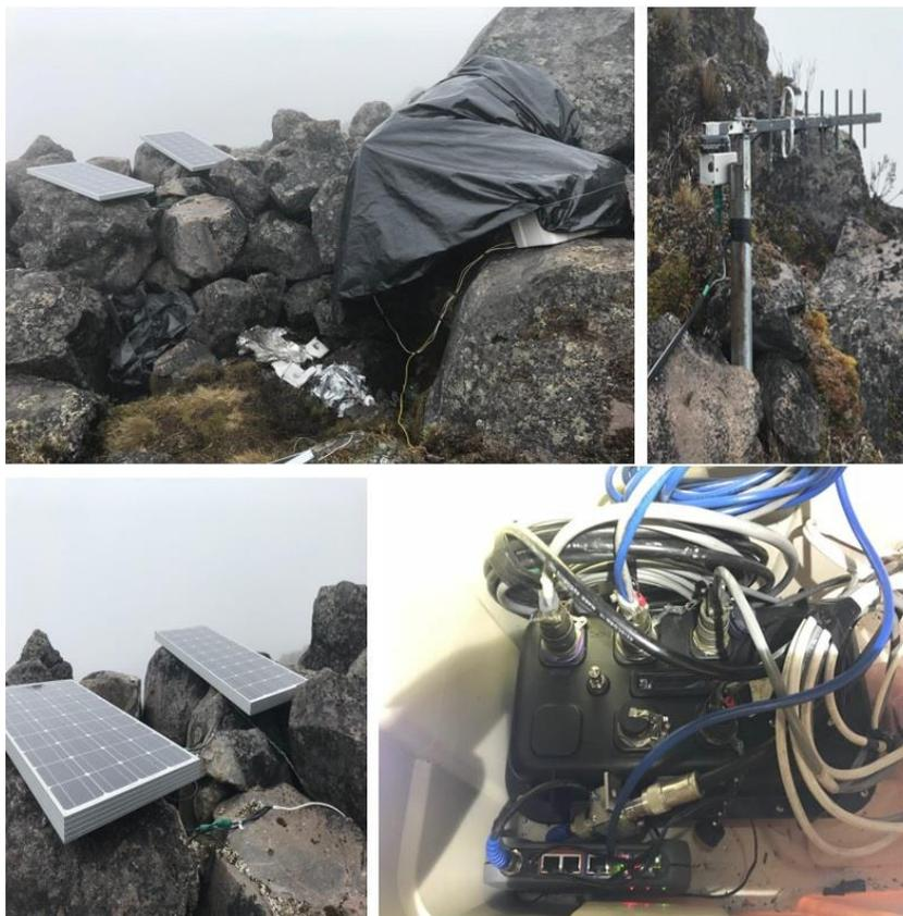
Fig 4: Digitalización estación período corto Antizana.
